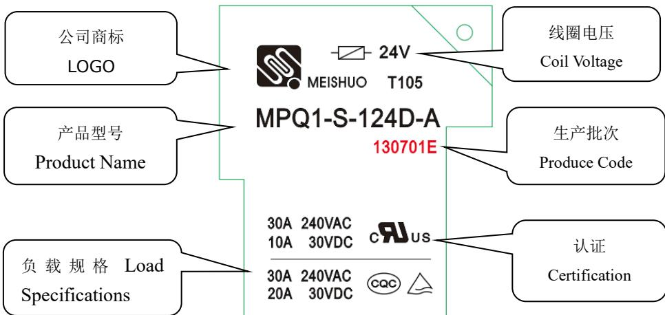
注：此印字图中批次号带“E”表示继电器可通过灼热丝测试
