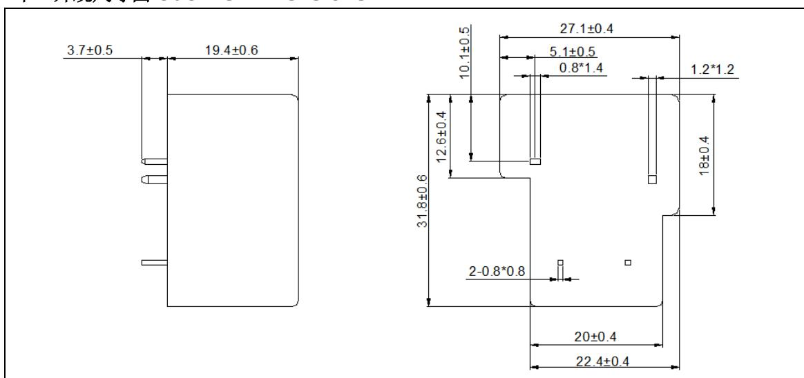
备注：外形图中产品部分未注公差尺寸，当尺寸 $\leq 1\text{mm}$ ，公差为 $\pm 0.2\text{mm}$ ；
