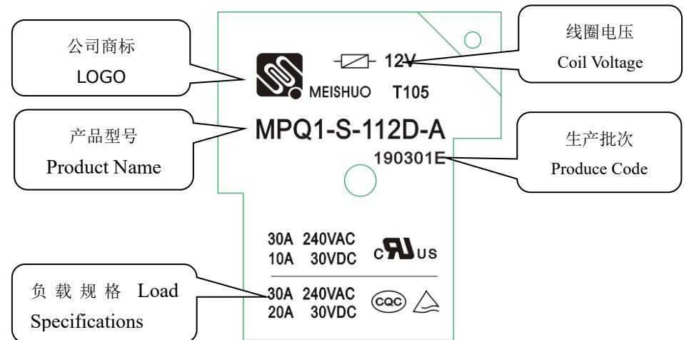
注：此印字图中批次号带“E”表示继电器可通过灼热丝测试
